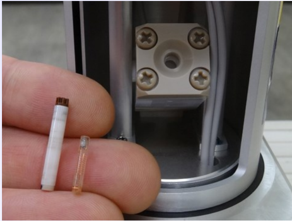
図2：JEOL RESONANCE 製高速回転装置(ベンチスピナ)、回転子、および、回転子に搭載する検出器の写真
